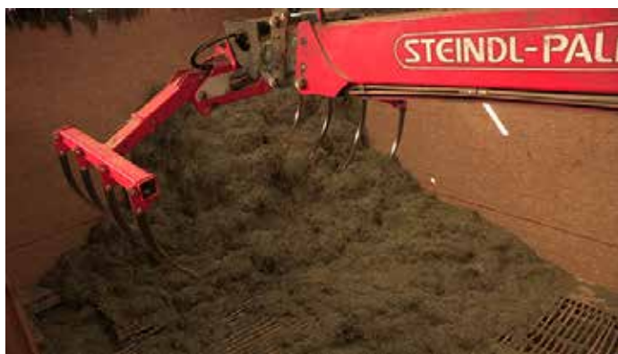
Le fourrage est disposé dans la cellule de stockage sur caillebotis.
